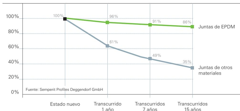
\*Comportamiento de una junta en caso de compresiones repetitivas, por ejemplo abriendo y cerrando la ventana. El comportamiento ideal es una recuperabilidad del perfil original, porque sólo así se garantiza un efecto hermético duradero.
